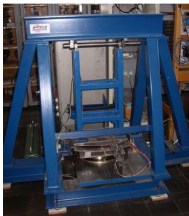
Bild 4: Forschung: Prüfstände für a) nutlosen PM-Synchronelektromotor (Antrieb für Stratosphären-Infrarot-Teleskop SOFIA), b) magnetisch schwebenden Antrieb 40 kW, 40000/min
