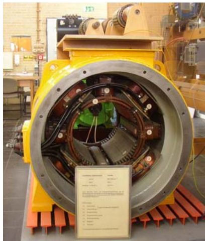
Bild 3: Lehre: a) Gleichstrommotor, b) PM-Synchronelektromotor
