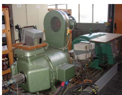
Bild 5: Forschung: a) Wirkungsgradmessung von Norm-Asynchronmotoren, b) 200 Hz-Sinusumformer 200 kW
